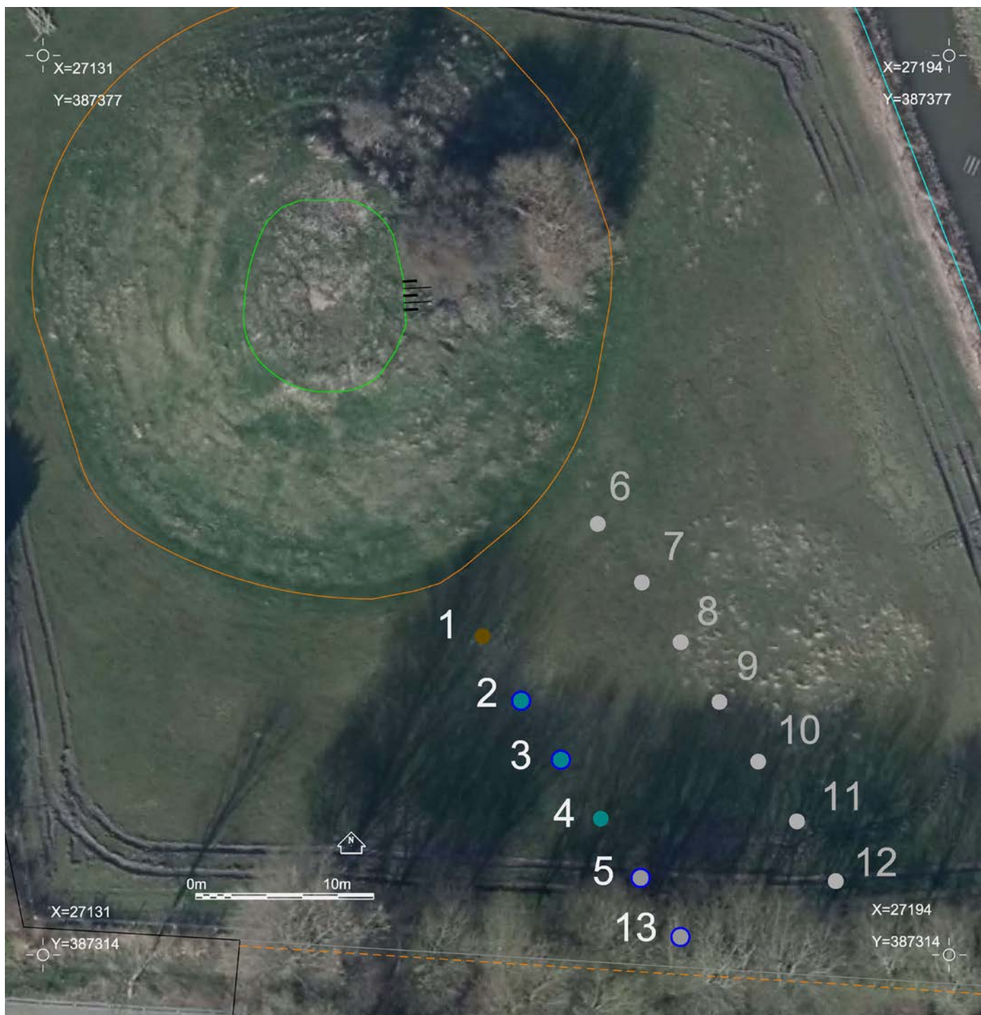
Fig. 12 Overzichtskaart met de locaties van alle boringen, geprojecteerd op een luchtfoto uit 2017. In bruin de boring met vrij intact Hollandveen (nr 1), De boringen met blauw omcirkeld zijn gracht/slootvullingen. In groen de boringen met mogelijke moernering (nrs 2-4), in grijs de recente sloot (nr 5-13). De grijze boringen (nrs 6-12) zijn vervallen.
