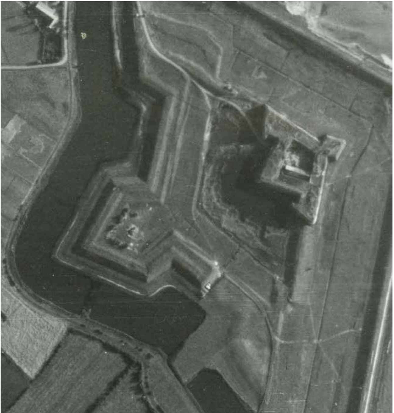
Fig. 72 Luchtfoto van de RAF, genomen in september 1944, een maand voor het doorschieten van de zeedijk. De foto geeft een schitterend beeld op het dan nog intacte Napoleonisch kroonwerk. Opmerkelijk is dat ook een restant van de Middeleeuwse dijk aan de zuidwestzijde nog bewaard is gebleven. Aan de noordoostelijke zijde is deze oude dijk al deels afgevlakt.
