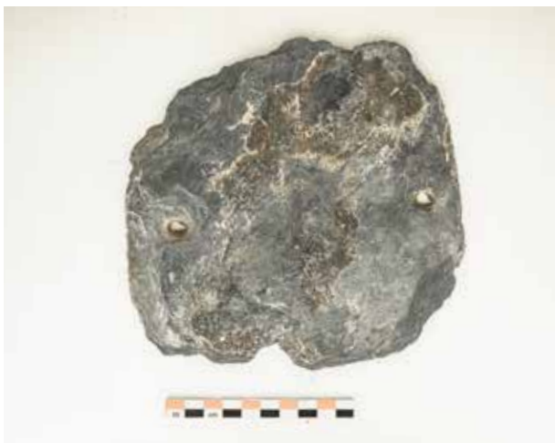
Fig. 104 Dakpan in leisteen. In de lei zijn doorboringen gemaakt om deze te bevestigen en fixeren.
