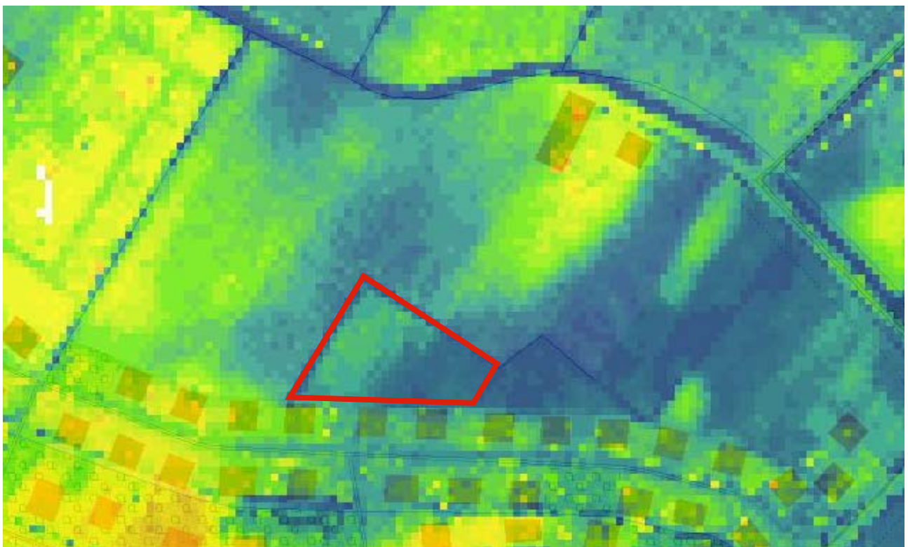
Fig. 4 Het onderzoeksgebied (rood omkaderd), geprojecteerd op het Actueel Hoogtebestand Nederland (AHN). De hooggelegen gebieden zijn groen/gele tinten weergegeven; de laaggelegen gebieden blauw. Bron: www.AHN.nl
