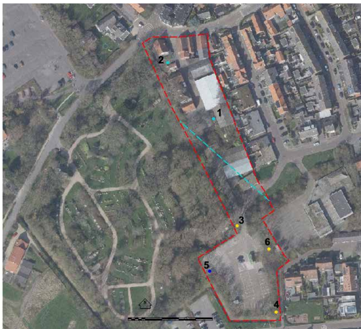
Fig.13 Het plangebied (rood omkaderd) met de boorpunten op de luchtfoto van 2017. In lichtblauw de boringen met kreekafzettingen, in geel met intact Hollandveen en in donkerblauw met slootvulling. Het globale verloop van de kreek staat lichtblauw aangegeven.
